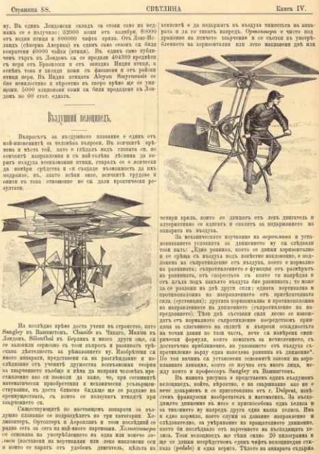
В ляво: Немски патент № 10842 от 1879 г. за хеликоптер с крачно задвижване на винтовете, съхраняван в Музея на хеликоптера в Бюкебург, Германия -
